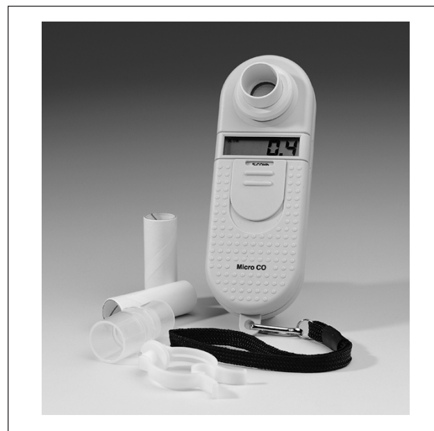
Abbildung 1: Mobiler handlicher CO-Monitor für die präklinische Messung der Kohlenmonoxidkonzentration in der Expirationsluft.
