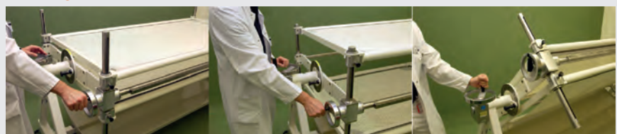
Hub und Rotation der Liegeflächen des Bauchlagerungsbettes LAD2009. Links: Liegeflächen in Minimalstellung (Bedienung per seitlich angeordnetem Getriebe über Handrad). Mitte: Liegeflächen in Maximalstellung für adipösere Patienten. Rechts: Bauchlagerungsbett während der Rotation (Bedienung über Zentral-Getriebe per Handrad).
